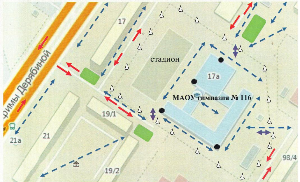
Схема организации дорожного движения в непосредственной близости от гимназии № 116 с размещением соответствующих технических средств, маршруты движения детей
